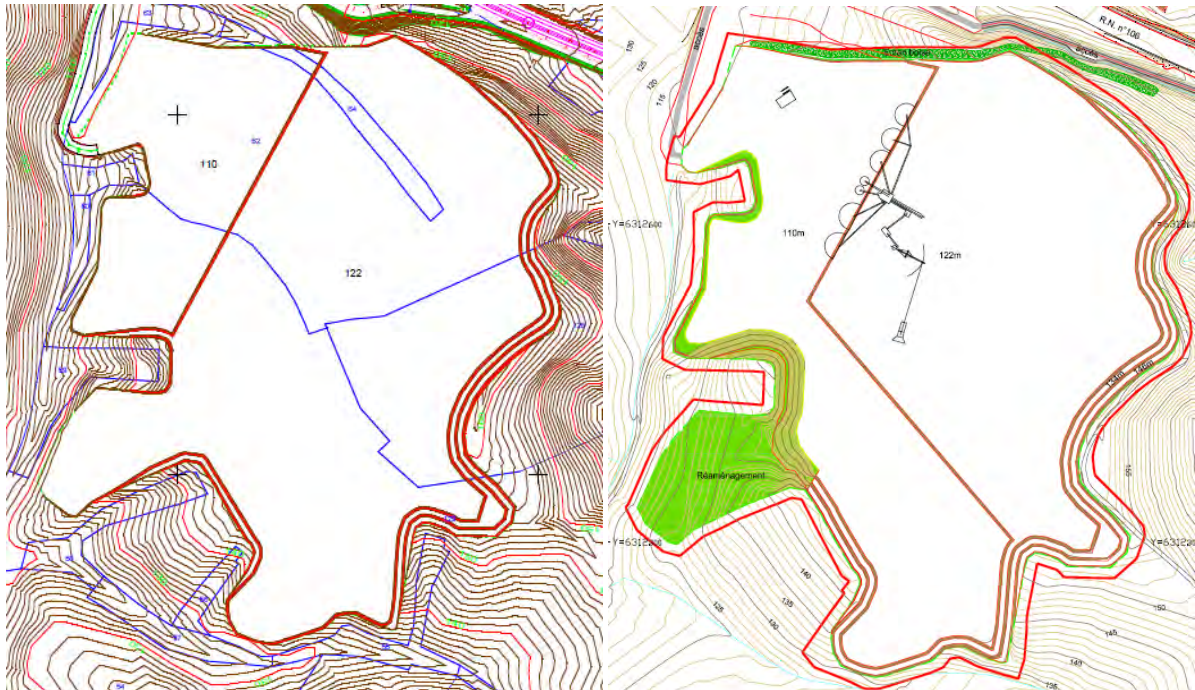
Illustration de la modification du phasage pour réduire l'impact paysager du projet, en favorisant le réaménagement coordonné à l'exploitation (phasage à T0 + 15 ans)
